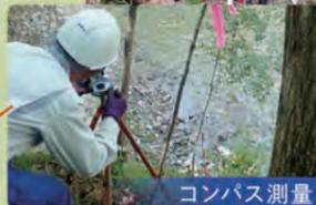
**コンパス測量** コンパスとエスロンテープ(間縄)を使用し、距離と方位角により、境界の位置の確認をします。
